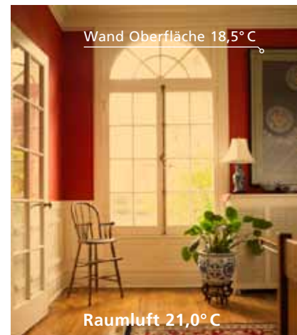
Nach der Innendämmung: Warme Wände schaffen Behaglichkeit schon bei geringerer Raumtemperatur.
